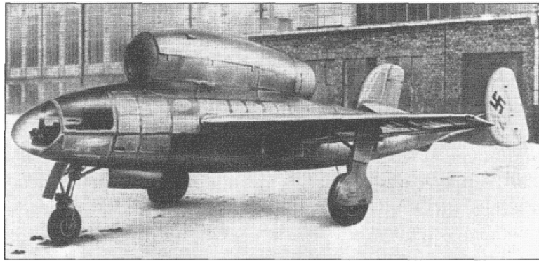
Henschel HS 132 A ›Anti-invasionsflugzeug‹ mit Flüssigluft-/Kohlenstaubbombe zur Erzeugung einer Großraumexplosion.
